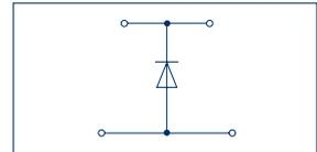
Двухуровневая клемма с электрон. компонентами
