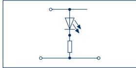
Двухуровневая клемма с электрон. компонентами
