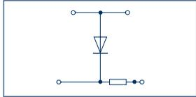
Двухуровневая клемма с электрон. компонентами
