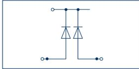
Двухуровневая клемма с электрон. компонентами
