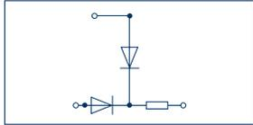
Двухуровневая клемма с электрон. компонентами
