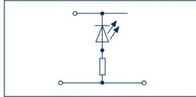
Двухуровневая клемма с электрон. компонентами
