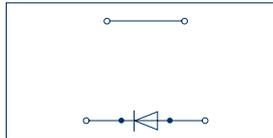
Двухуровневая клемма с электрон. компонентами
