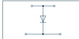
Двухуровневая клемма с электрон. компонентами
