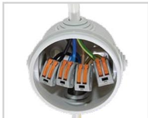
Для присоединения и ответвления до 5 одножильных проводников сечением от 0,1 мм<sup>2</sup> до 2,5 мм<sup>2</sup> и многожильных медных проводников сечением от 0,1 мм<sup>2</sup> до 4 мм<sup>2</sup> в электрических цепях переменного тока с частотой 50 Гц напряжением до 380 В.
