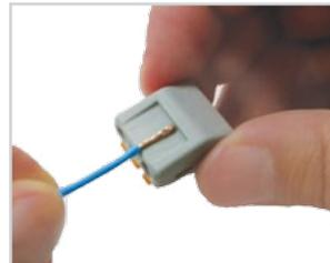
Снять изоляцию на 9-10 мм.
