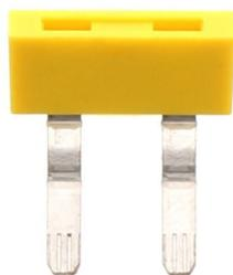
Aussenquerverbinder isoliert, Polzahl: 2, Montageart: Stecken, Breite: 16,1 mm, Bemessungsstrom: 27 A, Farbe: Gelb
