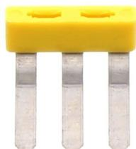
Aussenquerverbinder isoliert, Polzahl: 3, Montageart: Stecken, Breite: 14,36 mm, Bemessungsstrom: 27 A, Farbe: Gelb
