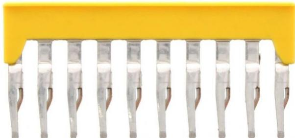
Querverbinder isoliert, Polzahl: 10, Montageart: Stecken, Breite: 49,9 mm, Bemessungsquerschnitt: 2,5 mm<sup>2</sup>, Farbe: Gelb
